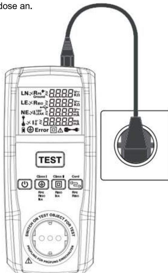
Sobald der Gerätetester eingeschaltet ist und der Kaltgerätestecker in der Schutzkontaktsteckdose eingesteckt ist, startet das Gerät die Spannungsmessung automatisch. Hierbei wird die Polarität der Leitungen angezeigt:
