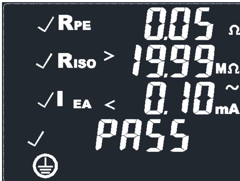
Nach der bestandenen Prüfung des Schutzleiterwiderstandes, des Isolationswiderstandes und des Ableitstroms, zeigt das Gerät das Bestehen der Prüfungen welche am Prüfling durchgeführt wurden mit den Worten „PASS“.
