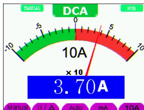
Abbildung 28: Gleichstrommessung <10 A (DCA)
