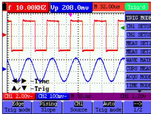
Figure 38: Edge Trigger
