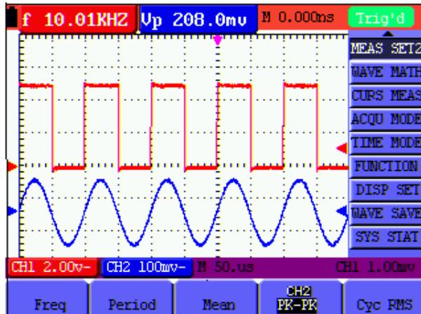
Abbildung 11: automatische Oszilloskop-Messungen
