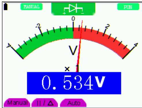
Abbildung 22: Diodenprüffunktion
