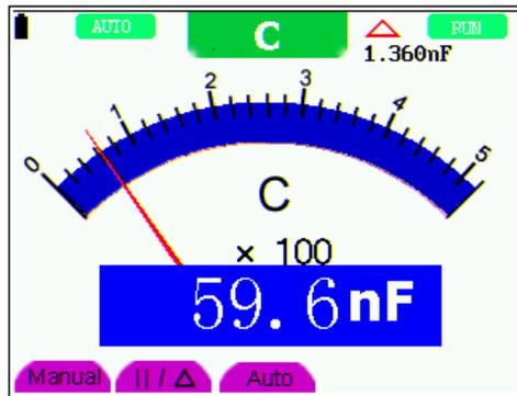
Abbildung 24: Kapazitätsmessung
