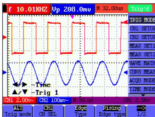
Abbildung 43: Alternate Trigger
