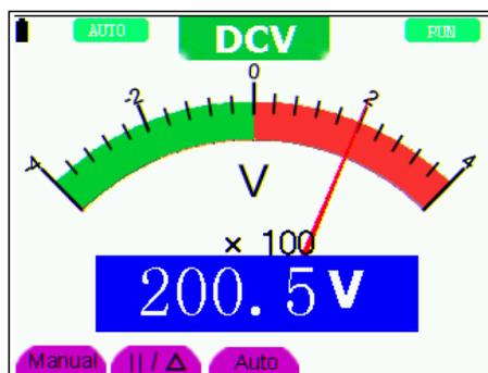
Abbildung 25: Gleichspannungsmessung (DCV)
